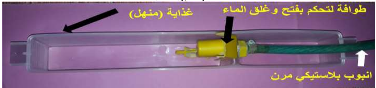
الشكل 7. أجزاء منظومة التبريد الداخلية للتحكم بفتح و غلق صنوبر الماء
