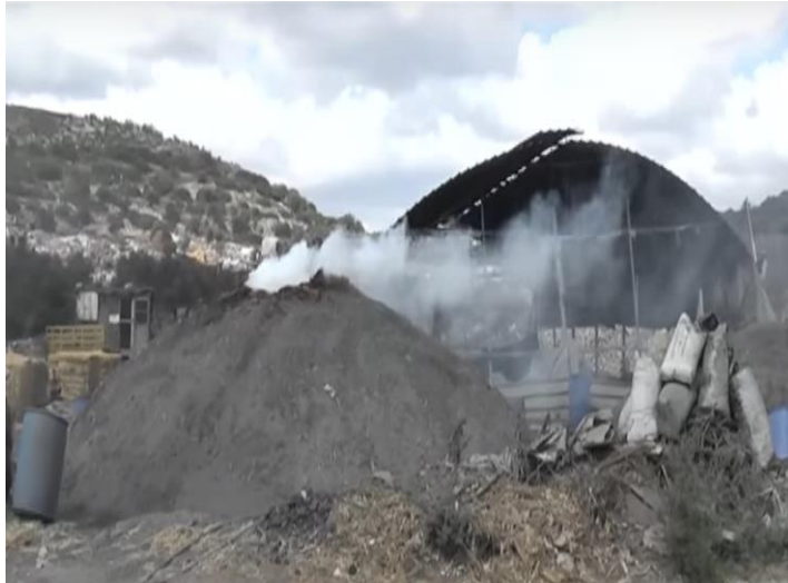
الصورة (2) يتم تغطية الخشب باكون من القش والتراب من اجل تجهيزها لعملية التفحيم
