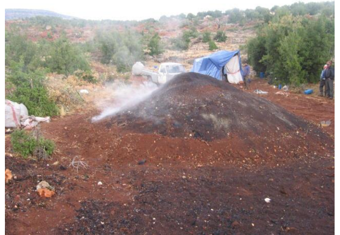
الصورة(3) تغطية الخشب باكوم من القش والتراب وطبقة من النايلون السميك لمنع وصول الاكسجين تجهيزا لعملية التفحيم.
