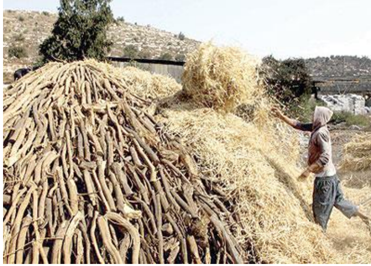
الصورة (2) يتم تغطية الخشب باكون من القش والتراب من اجل تجهيزها لعملية التفحيم
