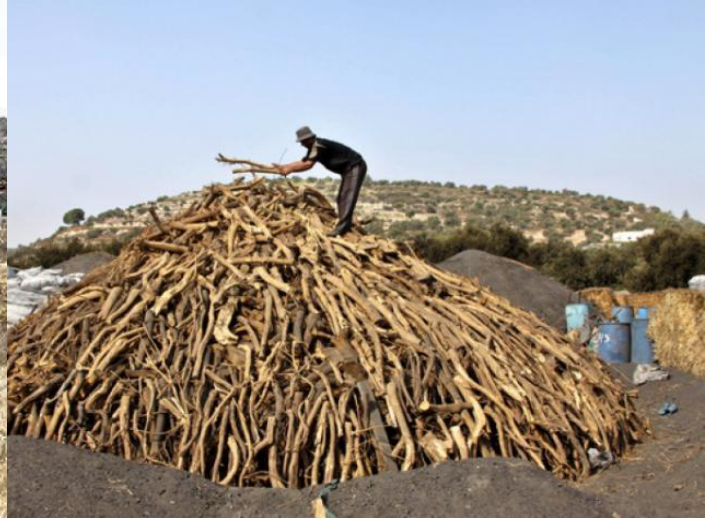
الصورة (1) ترتيب الخشب على شكل هرمي في المفحمة قبل علمية التفحيم
