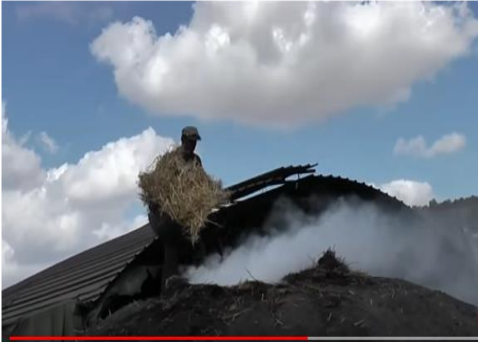
الصورة (10) عدم ارتداء العمال اقنعة واقية عند العمل بالمفاحم وعدم التزامهم بإجراءات السلامة العامة
