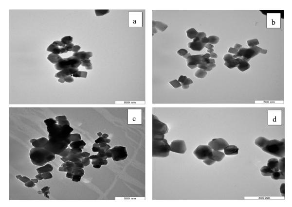
**Figure 5.** TEM images of catalysts: (a) Pt,Pd,Ni/MgO, (b) Pt,Pd,Ni/Mg<sub>0.97</sub>La<sup>3+</sup><sub>0.03</sub>O, (c) Pt,Pd,Ni/Mg<sub>0.93</sub>La<sup>3+</sup><sub>0.07</sub>O, (d) Pt,Pd,Ni/Mg<sub>0.85</sub>La<sup>3+</sup><sub>0.15</sub>O.
