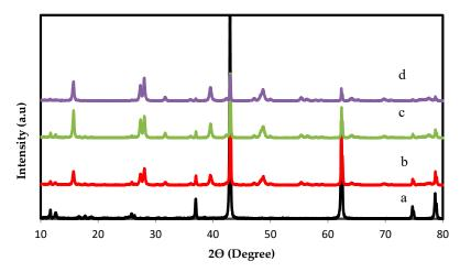
**Figure 1.** XRD patterns of the catalysts: (a) Pt,Pd,Ni/MgO, (b) Pd,Pd,Ni/Mg<sub>0.97</sub>La<sup>3+</sup> $_{0.03}$ O, (c) Pd,Pd,Ni/Mg<sub>0.93</sub>La<sup>3+</sup> $_{0.07}$ O, (d) Pd,Pd,Ni/Mg<sub>0.85</sub>La<sup>3+</sup> $_{0.15}$ O.
